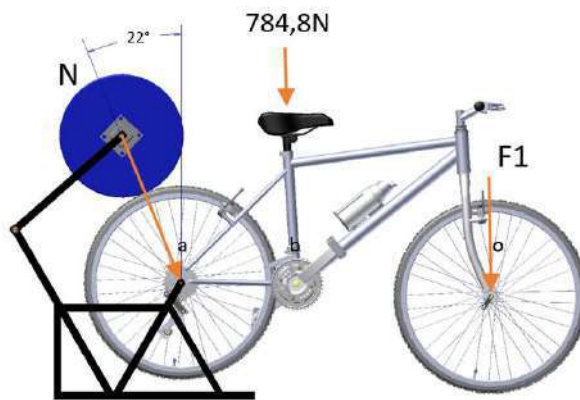
Figura 43: Diagrama cinemático de la máquina en funcionamiento.
