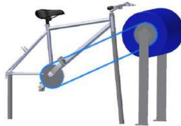
Figura 36: tambor giratorio impulsado por una bicicleta estacionaria.
