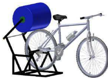
Figura 37: Tambor giratorio, impulsado por una bicicleta, con la opción de desplazamiento.
