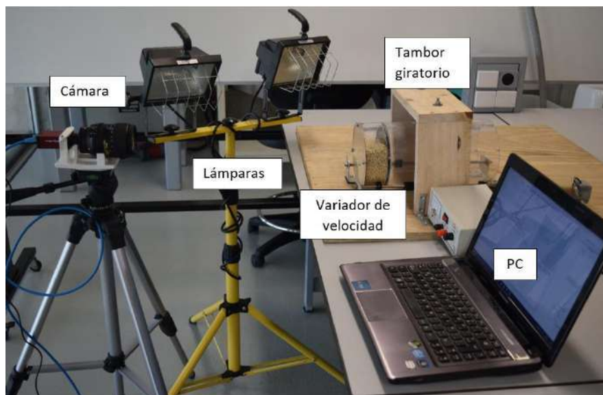
Figura 15: Configuración experimental para pruebas con PIV
