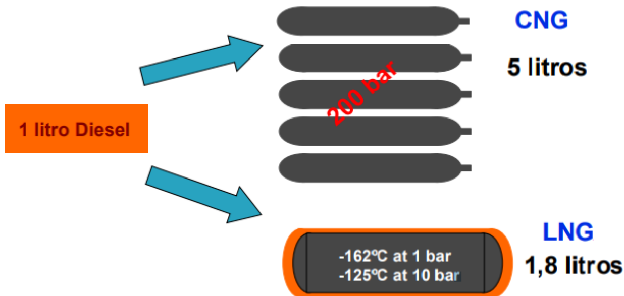
Figura N° 49 Equivalencia de energía entre el GNC y GNL vs Diésel Fuente: Asociación Ibérica de Gas Natural para la Movilidad, 2016 [55]
