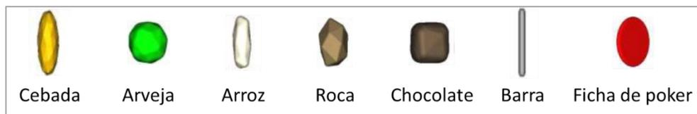
**Figura 1.26:** Rocky-DEM puede utilizar diferentes geometrías para las simulaciones.
